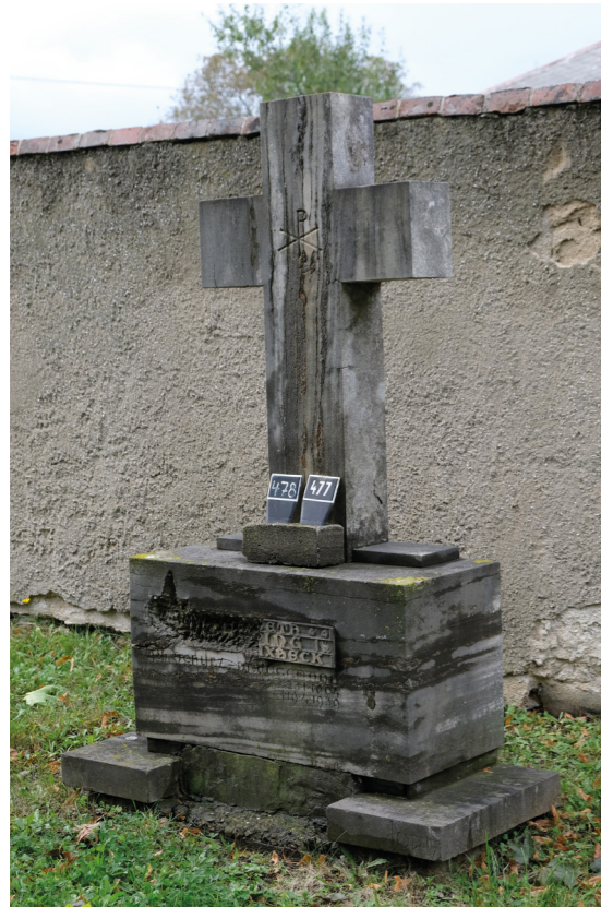
Obr. 3.2.14a, b Javorník (okr. Jeseník), městský hřbitov. Neznámý náhrobek využívá dekorativního charakteru smouhovitého mramoru. Přítomné sulfidy železa (pyrit) kámen silně degradují. Signováno „J. Obeth“.
